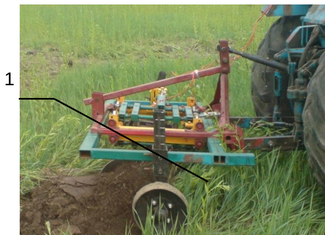
Рис. 5. Оранка корпусом плуга з експериментальною полицею: 1 – опорні колеса
