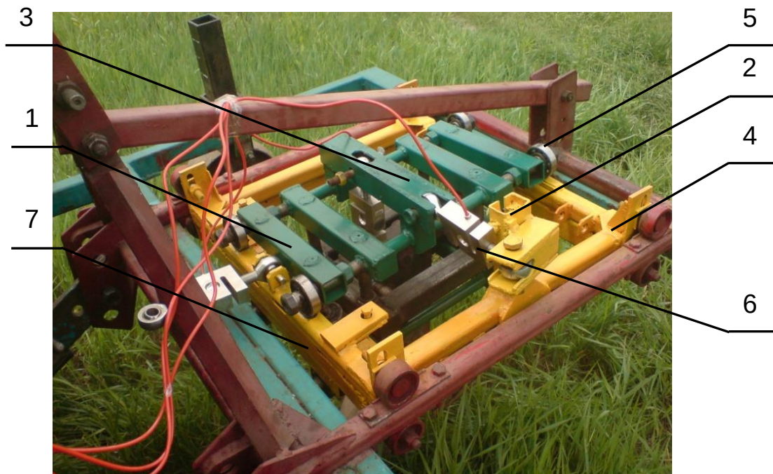
Рис. 2. Експериментальна установка: 1, 2, 3 – датчики для вимірювання відповідно поздовжньої, бокової та вертикальної складової результуючої сили опору; 4, 5, 6, 7 – рами, які сприймають відповідно поздовжню, бокову, вертикальну складові результуючої сили опору та рама для кріплення всієї конструкції до трактора.
