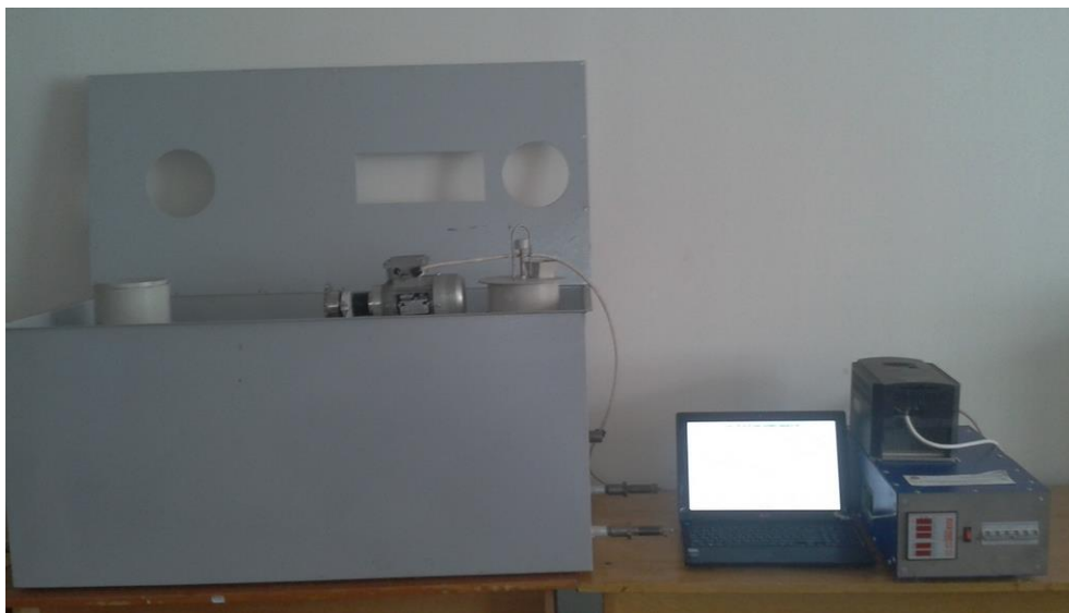
Рис. 2. Обертовий метантенк встановлено у зовнішній корпус.
