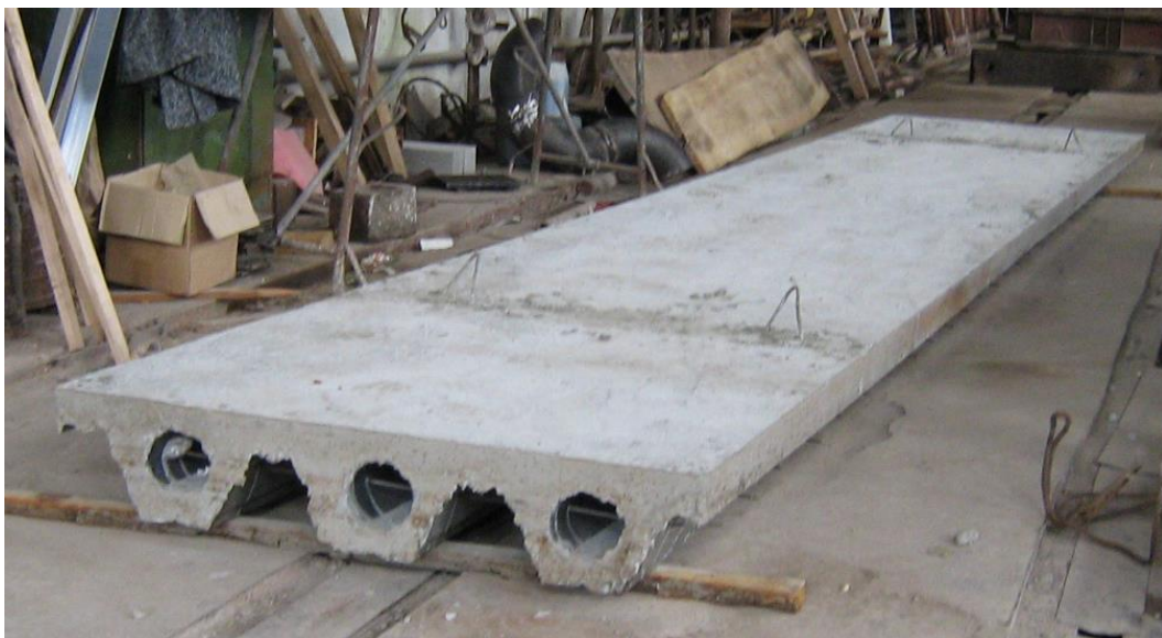
Рис. 4. Порожнисторебриста плита розміром 1000x6000 мм після виготовлення і розпалубки.
