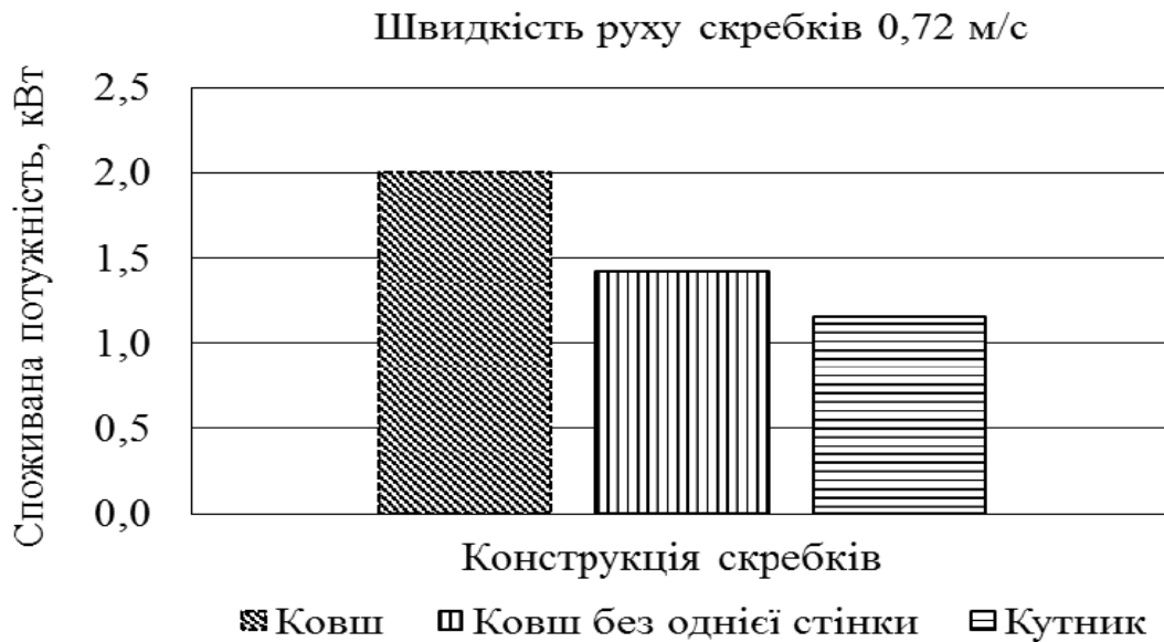
Рис. 2. Залежність споживаної потужності від конструкції розроблених скребків.
