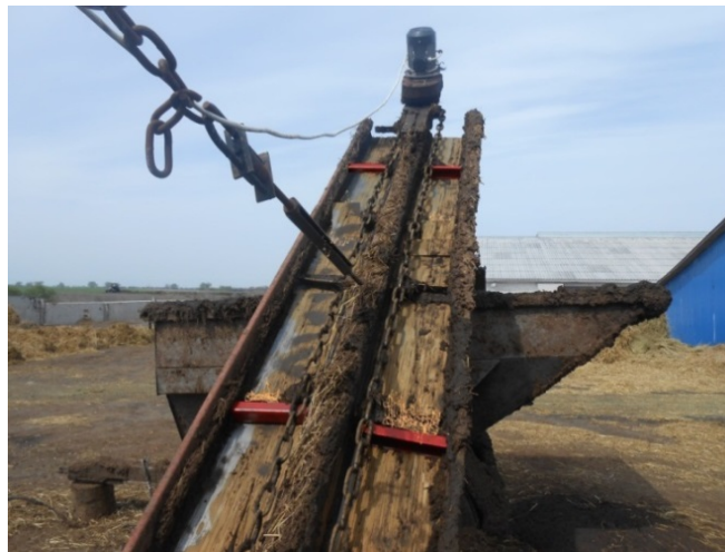
Рис. 4. Удосконалений похилий конвеєр у роботі.
