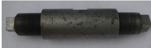
Рис. 2. Контейнер для визначення потенціалу масопереносу.
