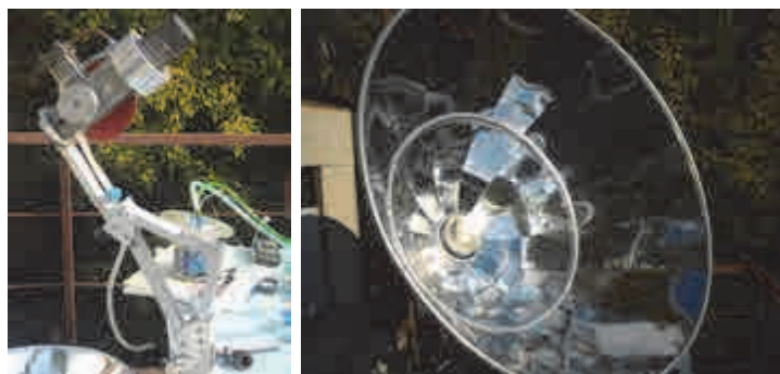
Рис. 2. Концентраторная теплофотоэлектрическая солнечная установка с двигателем Стирлинга
