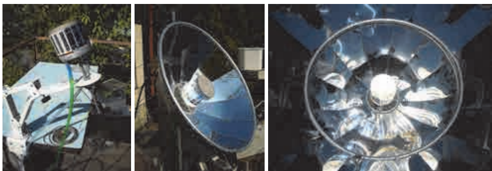
Рис. 3. Концентраторная теплофотоэлектрическая солнечная установка с планарными и высоковольтными матричными солнечными элементами
