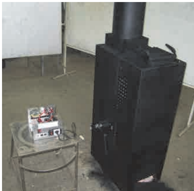
Рис. 2. Дослідний зразок автономної когенераційної системи електроживлення на базі біотеплогенератора
