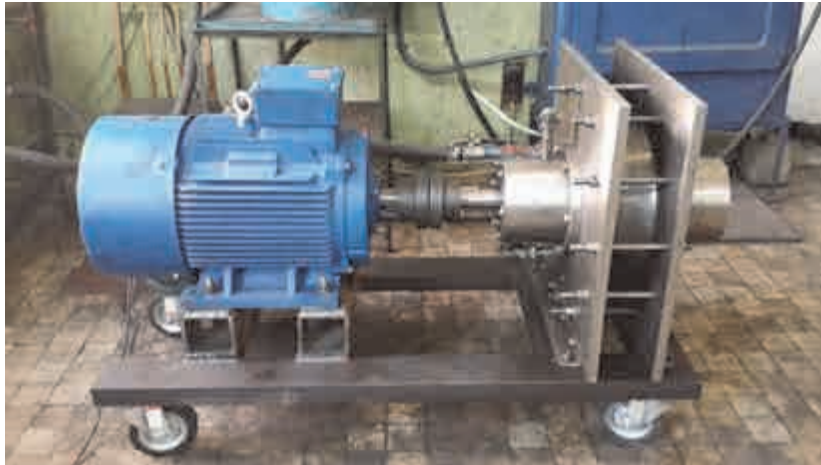
Рис. 1. Загальний вигляд теплогенератора РТГА-37
