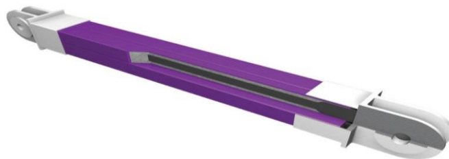
Рис. 9. В'язь від повздовжнього згину (Buckling restrained brace).
