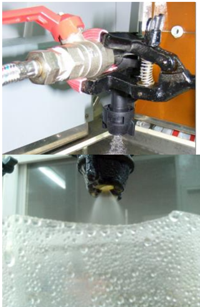
Рис. 4. Відцентровий повноконусний розпилювач "Disc and Core" фірми TeeJet.
