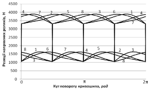
Рис. 4. Графіки зміни реакцій напрямних роликів N_{11} (1), N_{12} (2), N_{21} (3), N_{22} (4), N_{31} (5), N_{32} (6), N_{41} (7) та N_{42} (8) в залежності від кута повороту кривошипів.
