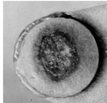
Рис.2. Зовнішній вигляд рухомого контакту із матеріалу СrН-10 електромагнітного пускача ПМЛ-1100А після 100 000 комутацій
