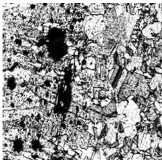
Рис.4. Мікроструктура контакту із матеріалу SrM-0,2 після 100 000 комутацій
