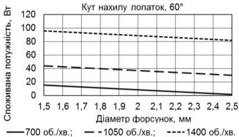
Рис. 1. Залежність споживаної потужності насоса від діаметра форсунок.
