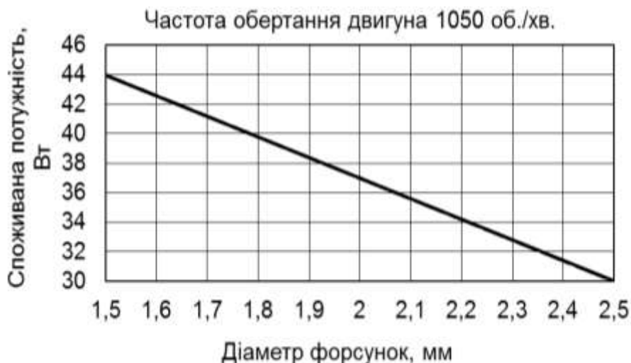
Рис. 4. Залежність споживаної потужності насоса від діаметра форсунок.
