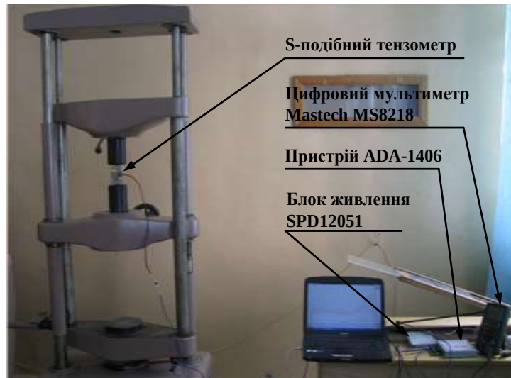
Рис. 6. Тарування датчика зусилля.
