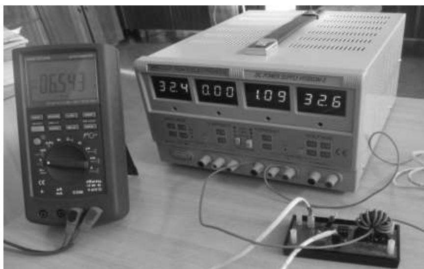
Рис. 2. Тарування датчика струму.
