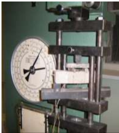
Рис. 1. Випробування фібробетонних балок, армованих мікрокристалічною фіброю і базальтофібробетонних стінових кілець Ø 1000 мм.
