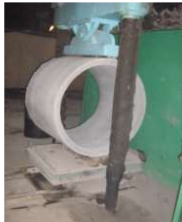
Рис. 1. Випробування фібробетонних балок, армованих мікрокристалічною фіброю і базальтофібробетонних стінових кілець Ø 1000 мм.
