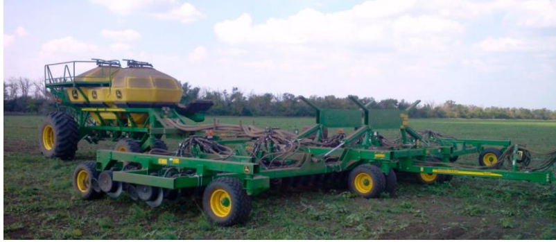
Рис. 1. Комбінований посівний машинно-тракторний агрегат John Deere 8345R + John Deere 1890+ John Deere 1910.
