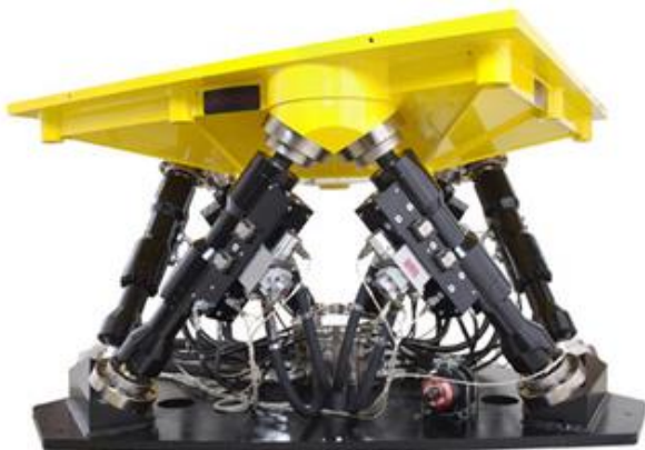
Рис. 1. Вібраційна установка MOOG (США): діапазон частот – низькі, середні, високі; кількість ступеней вільності – 6; тип приводу – гідравлічний сервопривод; комп'ютерна система управління режимом коливань.
