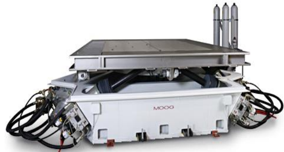
Рис. 4. Вібраційний стіл фірми MOOG (США): частота коливань – 50...100 Гц; кількість ступеней вільності – 6; тип приводу – гідравлічний.
