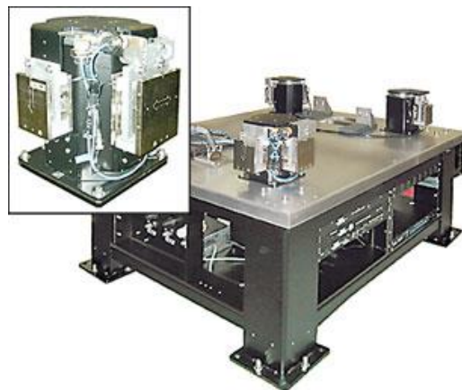
Рис. 2. Вібраційна установка TMC (США): діапазон частот – >100 Гц; кількість ступеней вільності – 6; тип приводу – електромагнітні збуджувачі; цифрова система управління.
