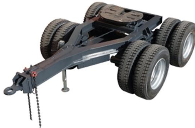
Рис. 2. Причіп підкатний возок тракторний Тонар ПТТ-0000020.
