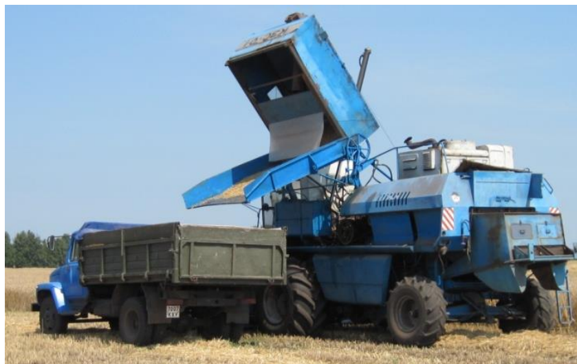
Рис. 2. Зернозбиральний комбайн з бункером-самоскидом.
