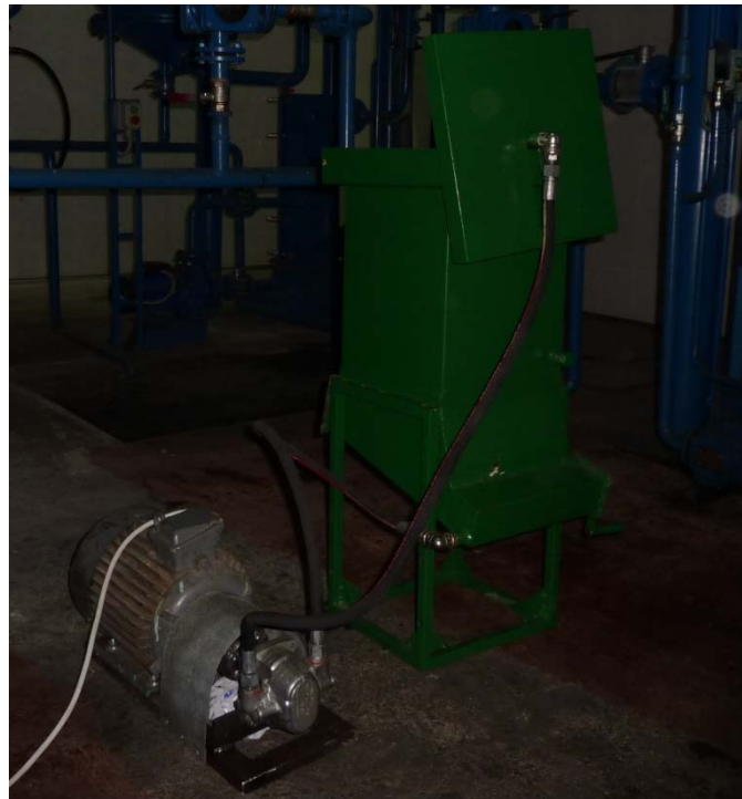
Рис 5. Обладнання для виробництва дизельного біопалива з гідромеханічним перемішуванням
