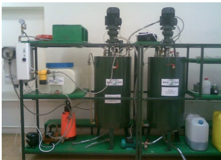
Рис. 3. Установка для одержання дизельного біопалива ЕКО-БІО
