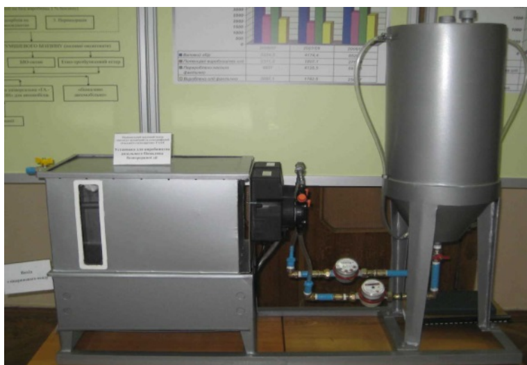
Рис. 2. Установка для одержання дизельного біопалива УБ-ТР-20
