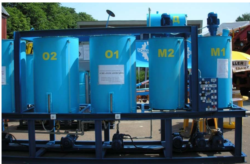
Рис. 1. Установка для одержання дизельного біопалива УВМЕ-1000
