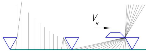
Рис. 2. Процес різання вовни різальною парою з обертовим характером рухом ножа.
