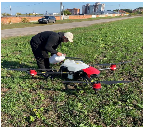
Рис. 4. Приготування концентрату та підготовка БПЛА до вильоту.
