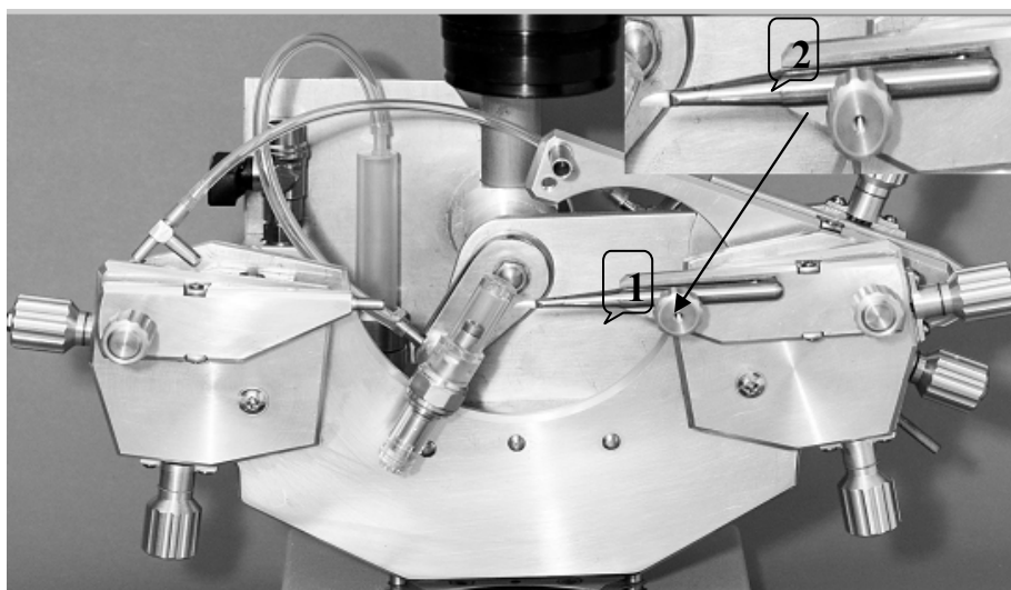
Рис. 2. Прилад для штучного введення сперми із встановленим пінцетоподібним фіксатором жала
