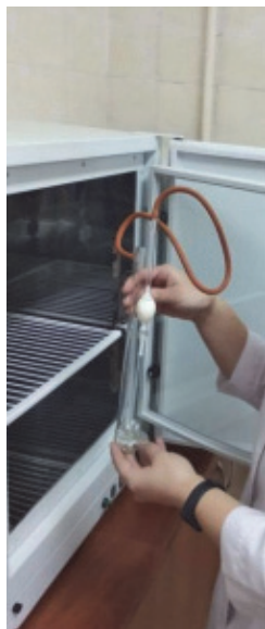
Рис. 2. Вимірювання умовної в'язкості на віскозиметрі Освальда
