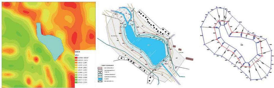
Рис.3. Картограма крутизни схилів, план-схема і розмічувальне креслення встановлених меж водоохоронної зони та прибережної захисної смуги навколо ставка с. Гремяче Рівненської області
