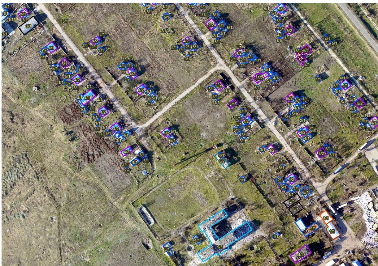
Рис. 8. Векторизований ортофотоплан селища Посад-Покровське
