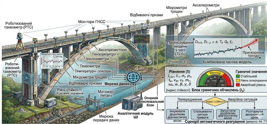
Рис. 2. Інтелектуальна система моніторингу та прогнозування деформацій мостової споруди на основі ТІМ (Технології Інформаційного Моделювання) та ШІ (побудовано авторами в середовищі SolidWorks)
