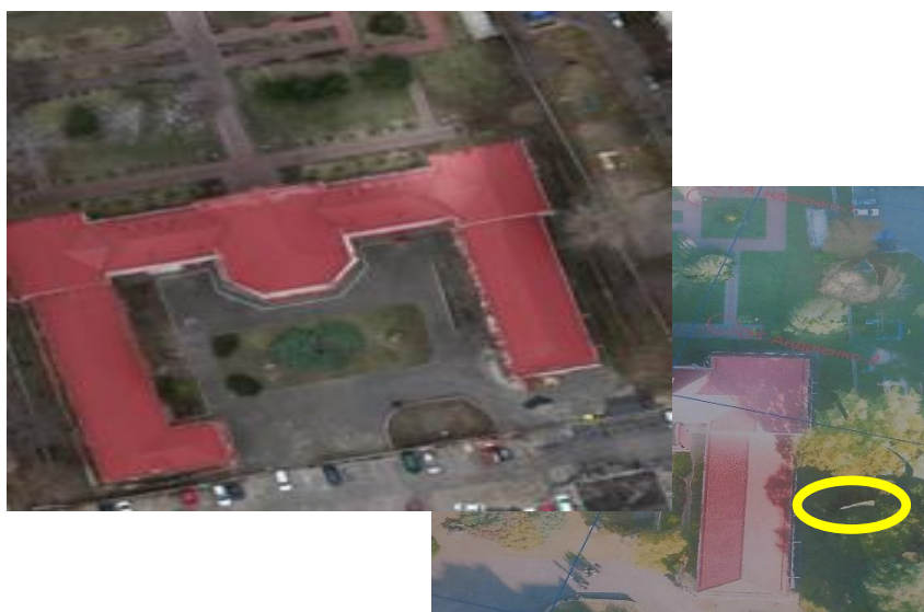
Рис. 3. «Розриви» зображення ортофотоплана при застосуванні різних алгоритмів його побудови
