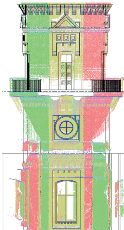
Рисунок 7. Високоточне 2D креслення на основі BIM моделі
