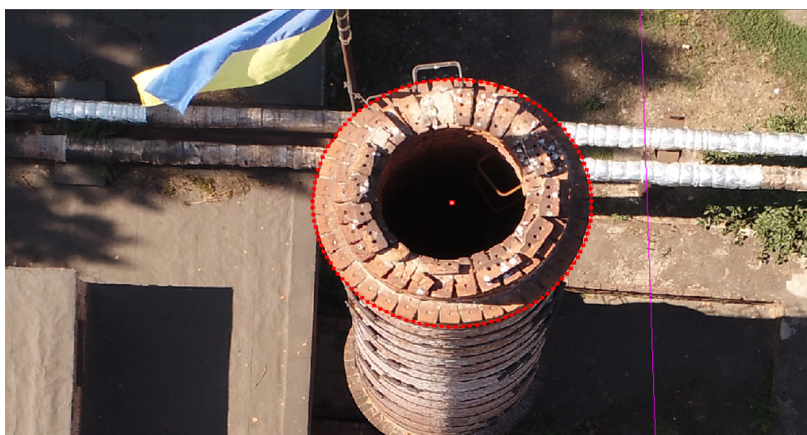
Рис. 3 – Результат формування геометрично скоригованого контуру верхнього перерізу димової труби після редагування опорних точок
